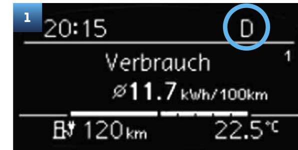
Je nach ausgewählter Fahrstufe erscheinen die folgenden Symbole oben rechts im Display des Kombi-Instruments ⇒ ⚠:
